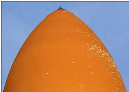
Поврежденный градом топливный бак Atlantis
